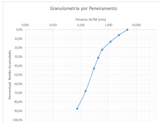
Gráfico 01: Curva Granulométrica – Solo IFPB. Fonte: Autores, 2017.
